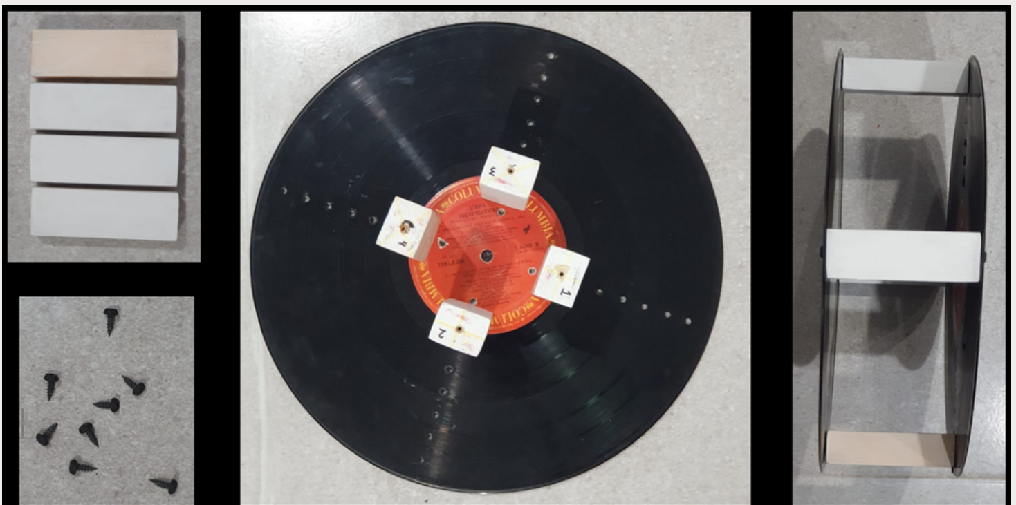
Fig. 3. En la parte izquierda de la imagen se pueden observar los bloques de madera y las pijas metálicas usadas. En la parte central de la imagen se muestra cómo se pueden distribuir los bloques de manera simétrica. En la parte derecha se presenta el sistema de cuerpo rígido visto de manera lateral.
