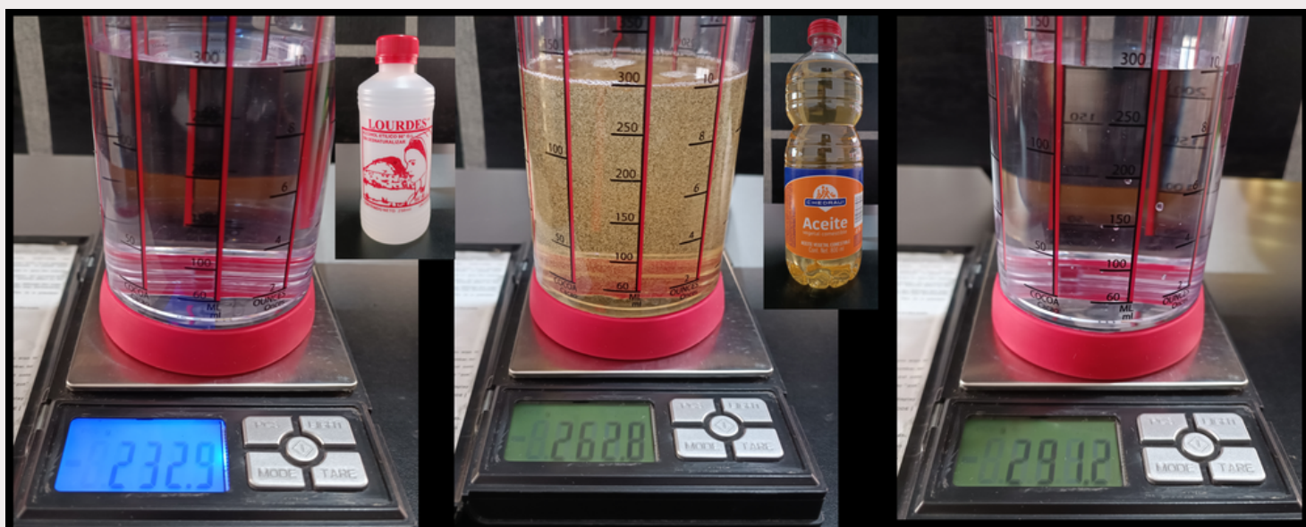
Fig.1. Medición de la relación entre la masa y el volumen para el alcohol, aceite vegetal y agua de la llave.
