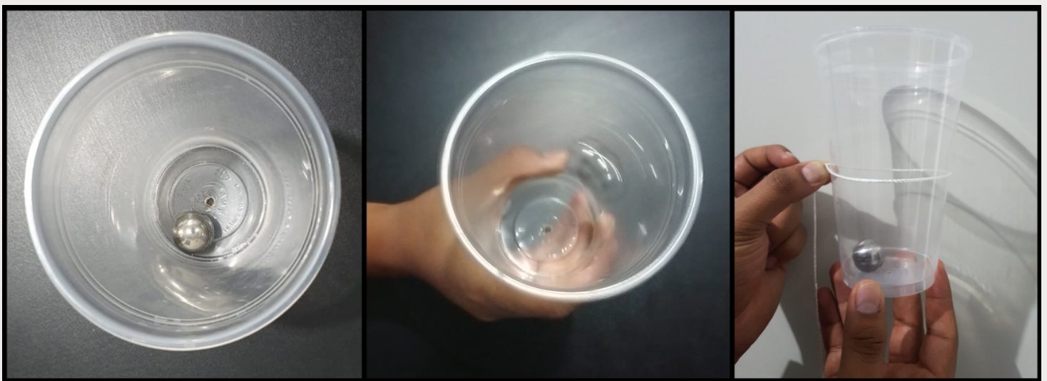
Fig. 3. Diseño del prototipo correspondiente al experimento 1 para determinar el valor de la gravedad por medio del concepto de fuerza centrípeta
