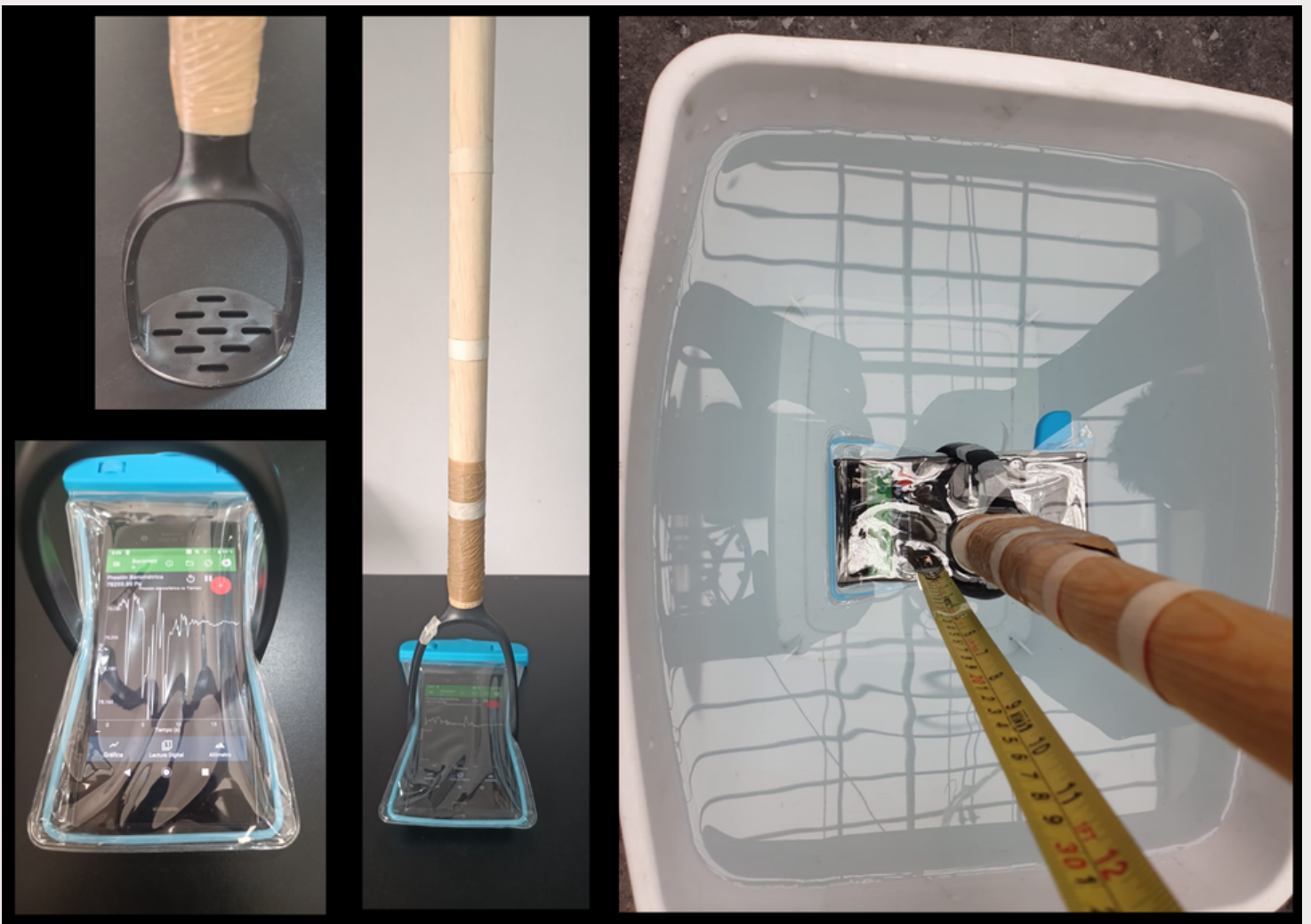
Fig. 3. Montaje experimental para medir la variación de la presión con respecto a la altura.
