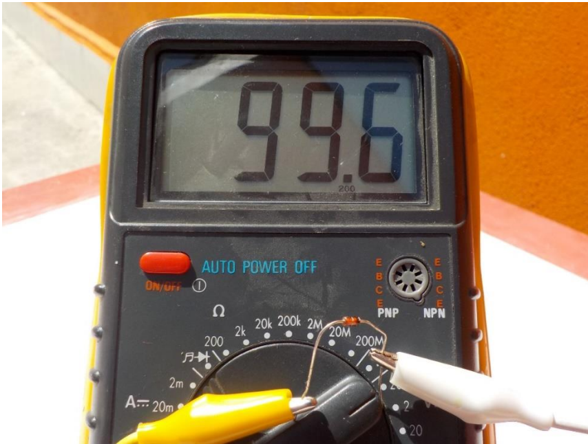
Figura 1. Conexión del diodo al voltímetro. (Escala de milivolts)
