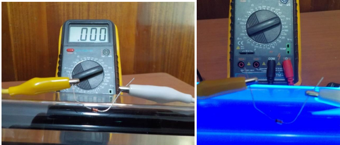
Figura 4. El diodo antes (izquierda) y después (derecha) de ser expuesto a la fuente UV tipo A.
