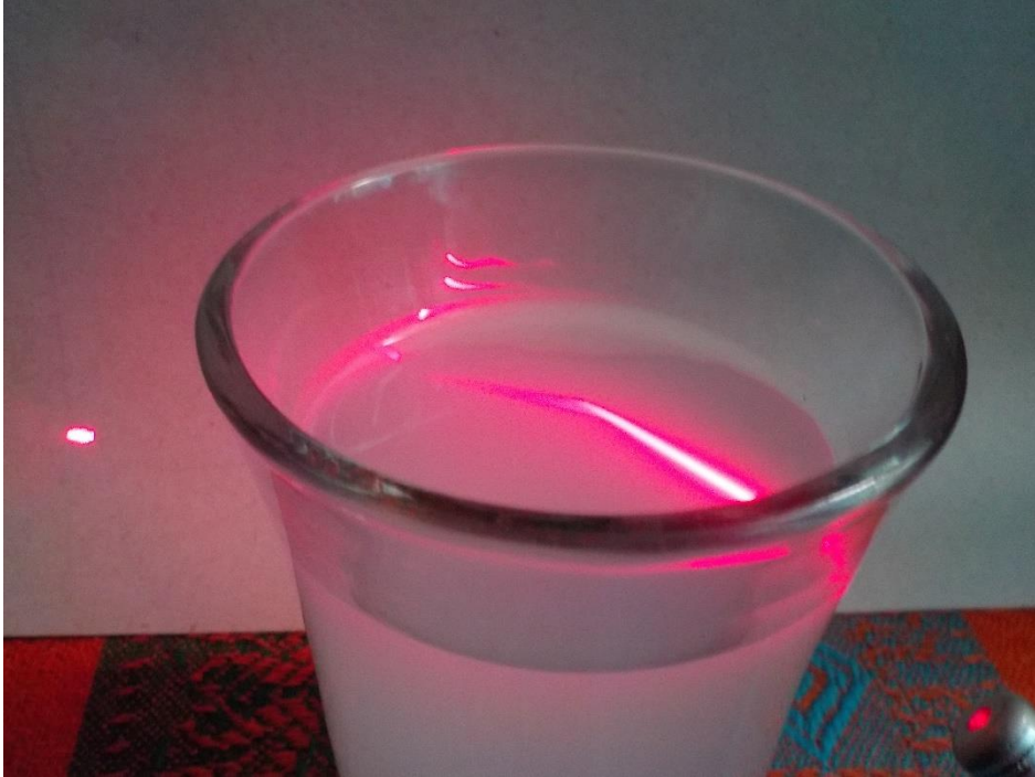
Figura 4. Haz láser sobre la superficie de un vaso con una mezcla de agua y leche.
