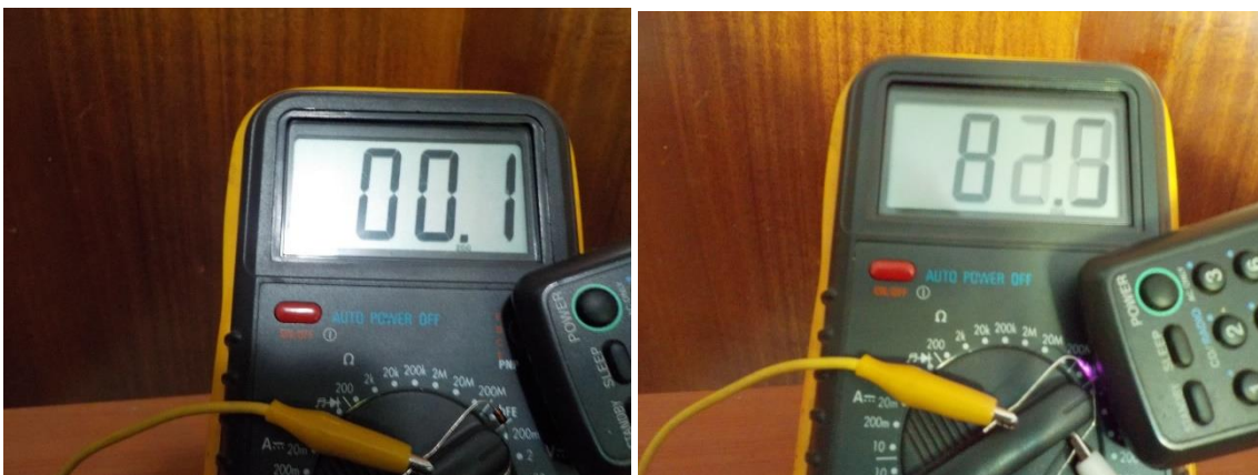
Figura 2. Antes (izquierda) y después (derecha) de activar el control remoto sobre la zona semitransparente del diodo.
