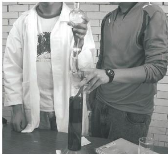
Figura A4.4. Sistema de llenado de la probeta con las disoluciones a distintas concentraciones.
