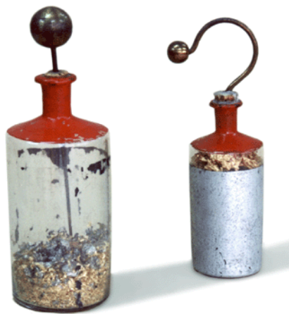
La botella de Leyden fue descubierta simultáneamente por Pieter van Musschenbroek y Ewald Georg von Kleist. Sirve para almacenar electricidad estática y es el prototipo más antiguo del condensador que actualmente se utiliza en aparatos electrónicos. http://www.xtec.es/centres/a8013111/alumnes/Gabinet/botleyden.html
